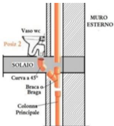
Fig. 1a – Dettaglio di un impianto di scarico con braga ad U in evidenza
